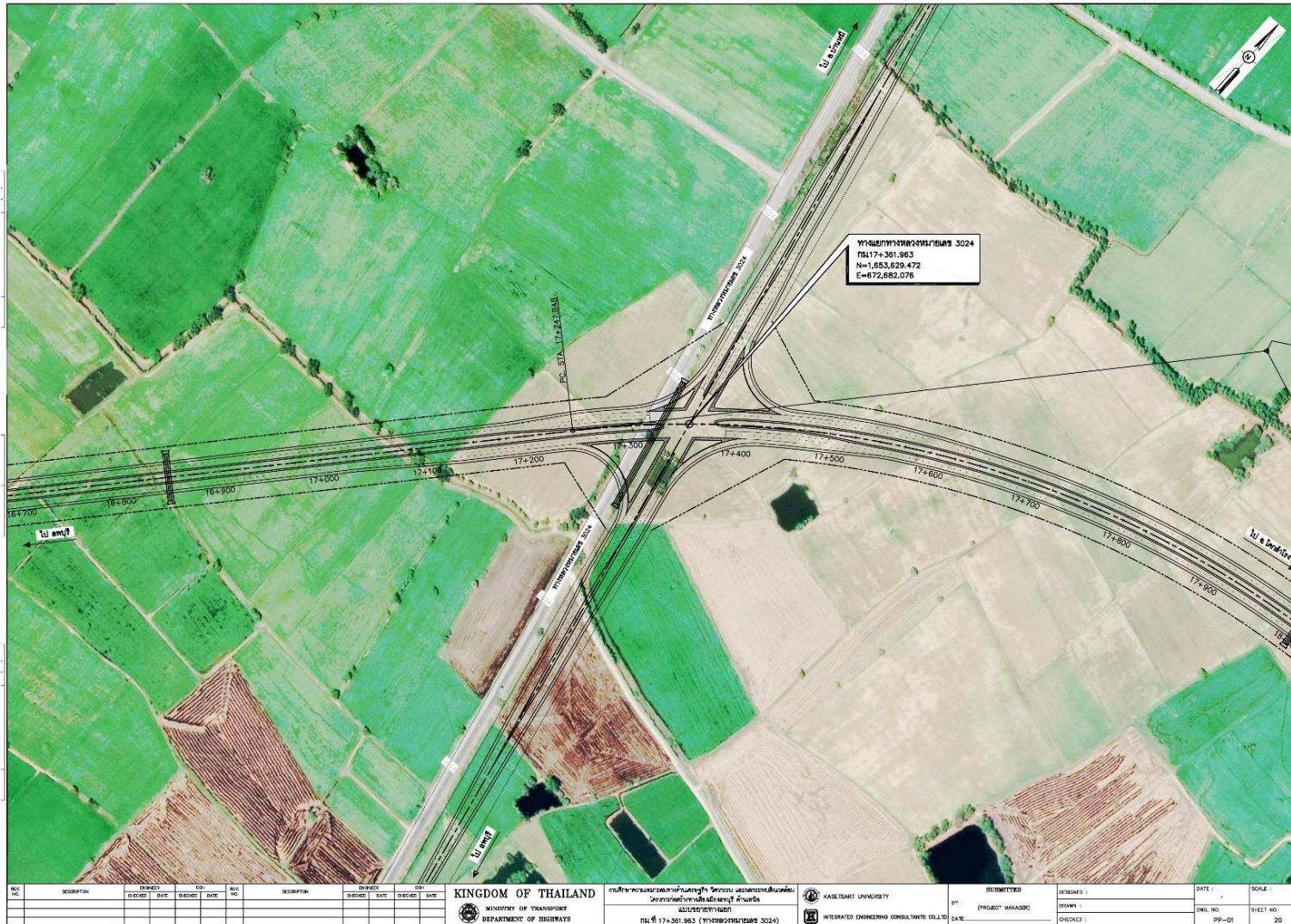
รูปที่ 6-3 รูปแบบทางแยกบริเวณจุดตัดทางหลวง 3024 (ส่วนที่ 1) - ทางแยกควบคุมสัญญาณไฟจราจร
